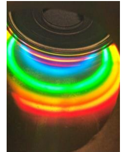
Espectre d'emissió de llum d'una bombeta de baix consum (llum càlida) obtingut amb un espectroscopi de sobretaula
